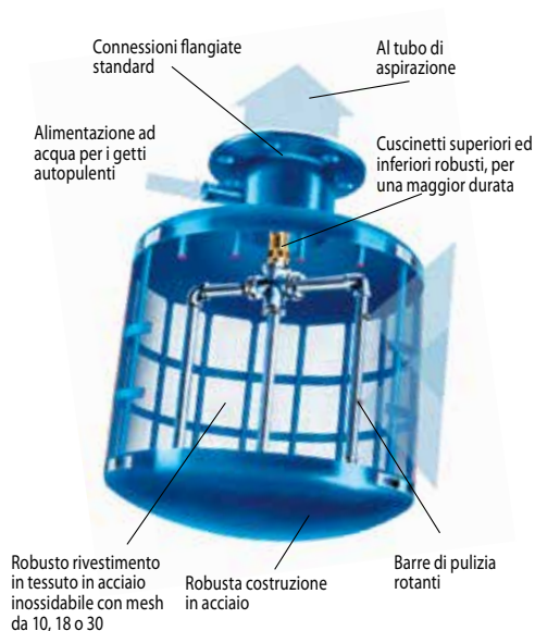
Filtro di aspirazione autopulente
