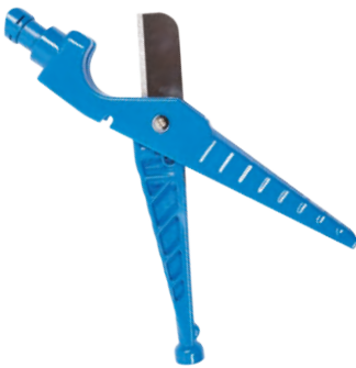
Uniwersalne narzędzie do emiterów P/N HEMT (Służy do wiercenia otworów, wykonywania i wyjmowania emiterów, oraz do przycinania przewodów)
