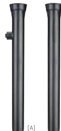
[A] PROS-12-SI [B] PROS-12 Hauteur rétractée : 41 cm Hauteur escamotable : 30 cm Diamètre exposé : 5,7 cm Entrée : ½"
