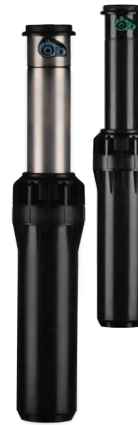
I-25-06 Hauteur totale : 26 cm Hauteur escamotable : 15 cm Diamètre exposé : 5 cm Taille de l'entrée : 1" BSP
